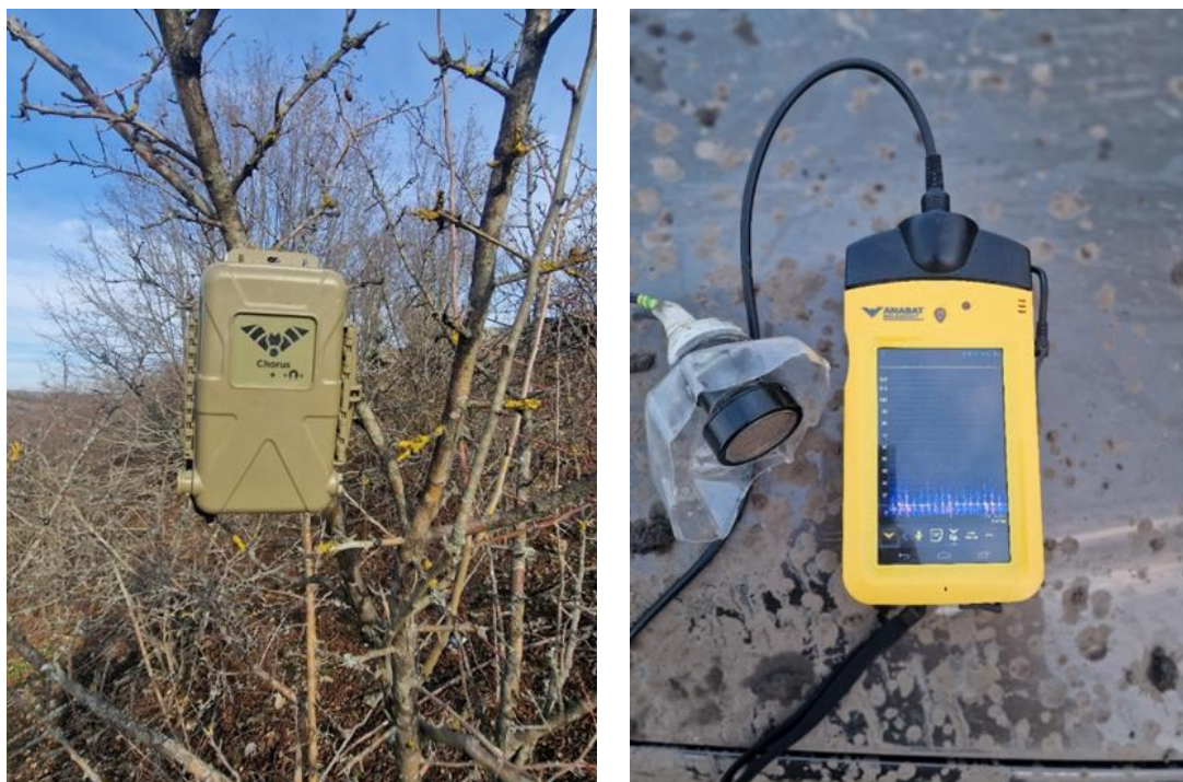
Figura 37. Detector manual pentru transectele de ultrasunete – Tip Anabat Walkabout cu GPS încorporat (dreapta), Detector static – Tip Anabat Chorus cu GPS încorporat (stânga)
