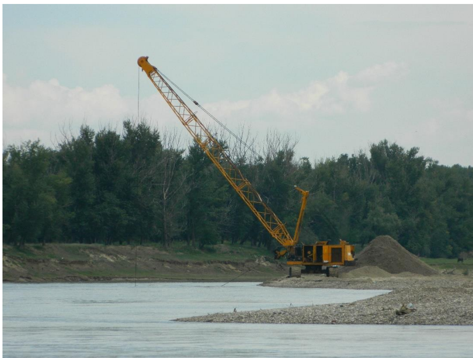
Fig. 26 Exploatarea agregatelor minerale direct din șenalul principal (exploatarea de pe malul drept mai în aval, iulie 2018)
