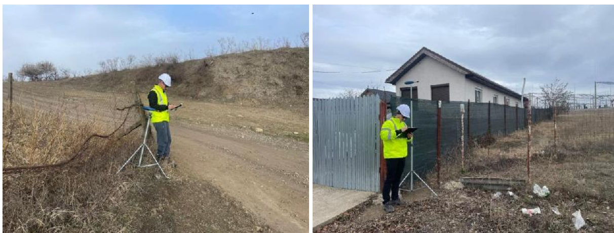
Foto 6.5 Măsurarea nivelului de zgomot la receptor
