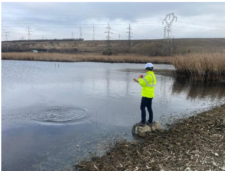
Foto 6.1. Prelevare probe apă de suprafață
