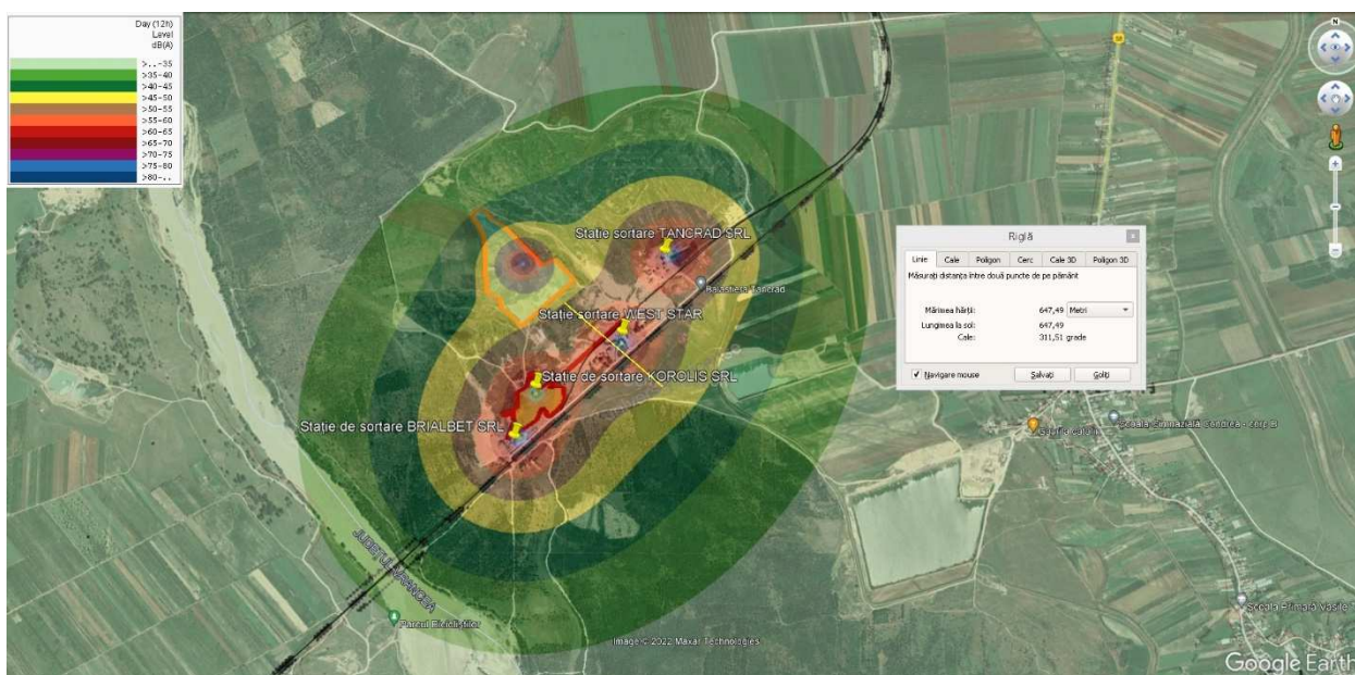
Figura nr. 6. Nivelul estimat de zgomot cumulat cu proiectele deja existente sau în curs de implementare
