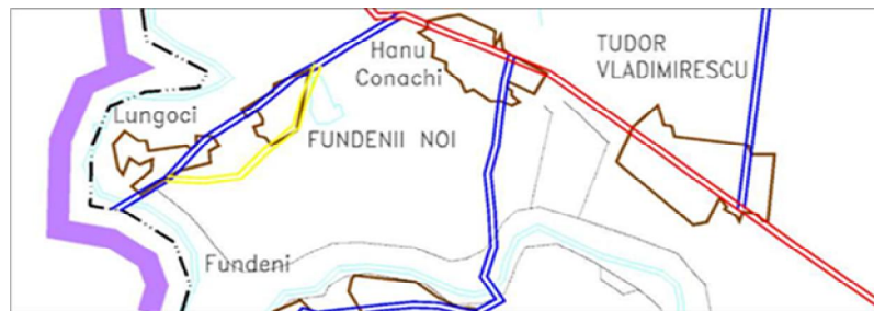
Figura VI.6-2 – Sistemul de alimentare cu apă UAT Fundeni
