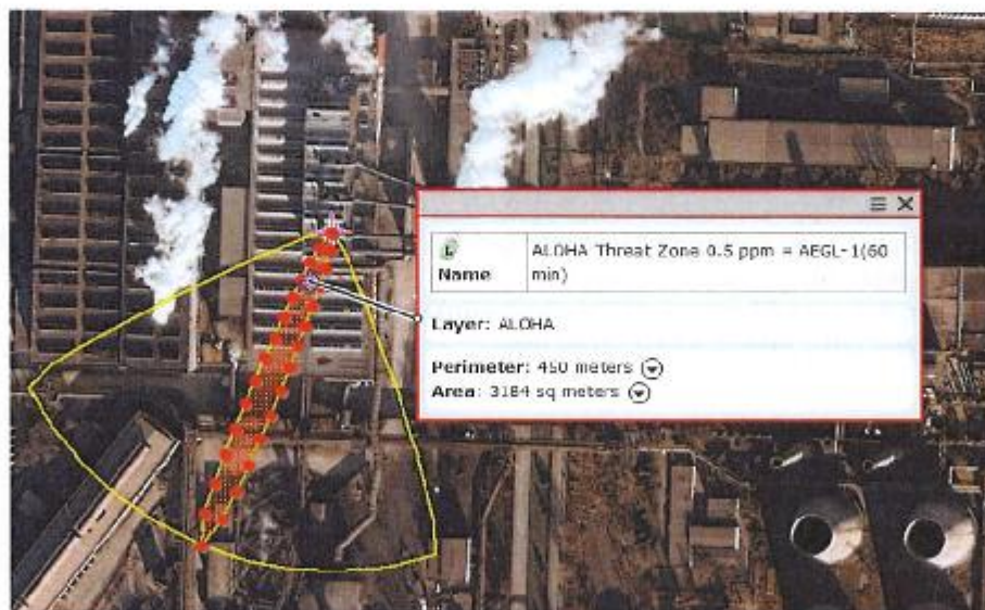
Zona de impact Convertizor nr. 3 – Dioxid de azot (NO 2 ) Galben: 223 m; Perimetru: 450 m; Suprafața: 3184 mp; Conc. 0,5 ppm = AEGL-1 (60 min)
