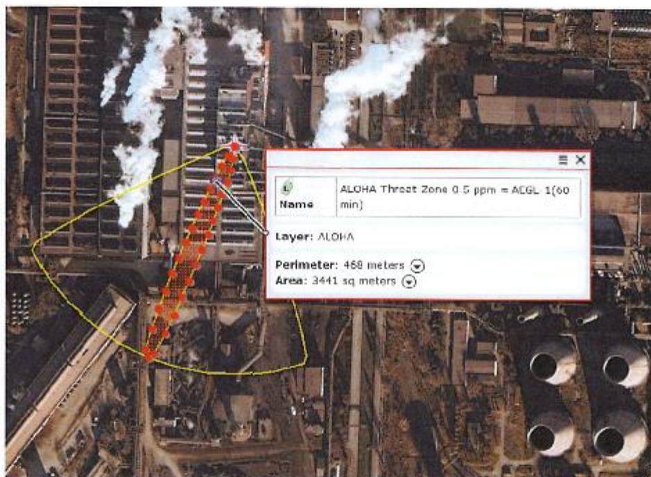
Zona de impact Convertizor nr. 2 – Dioxid de azot (NO 2 ) Galben: 231 m; Perimetru: 468 m; Suprafața: 3441 mp (Conc. 0,5 ppm – AEGL – 1 (60 min))
