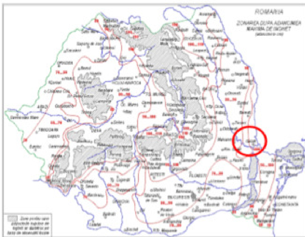
Figura nr. 16: Zonarea teritoriului României după adâncimea de îngheț, conform STAS 6054/77 „Adâncimi maxime de îngheț”
