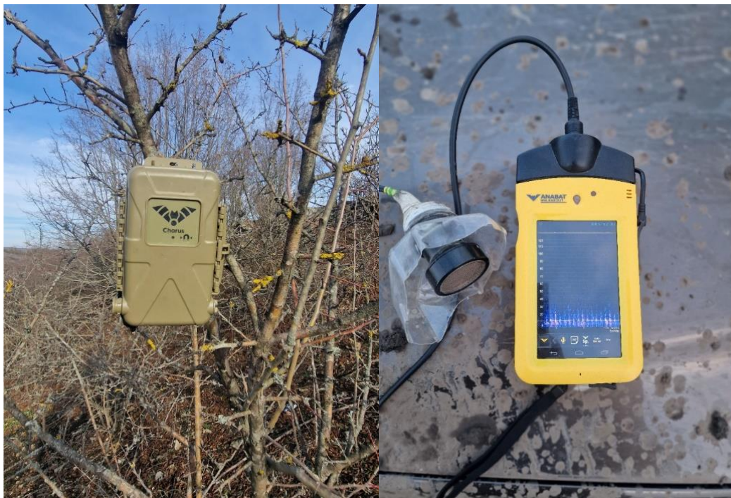
Figura 31: Detector manual pentru transectele de ultrasunete – Tip Anabat Walkabout cu GPS incorporat (dreapta), Detector static – Tip Anabat Chorus cu GPS incorporat (stânga)
