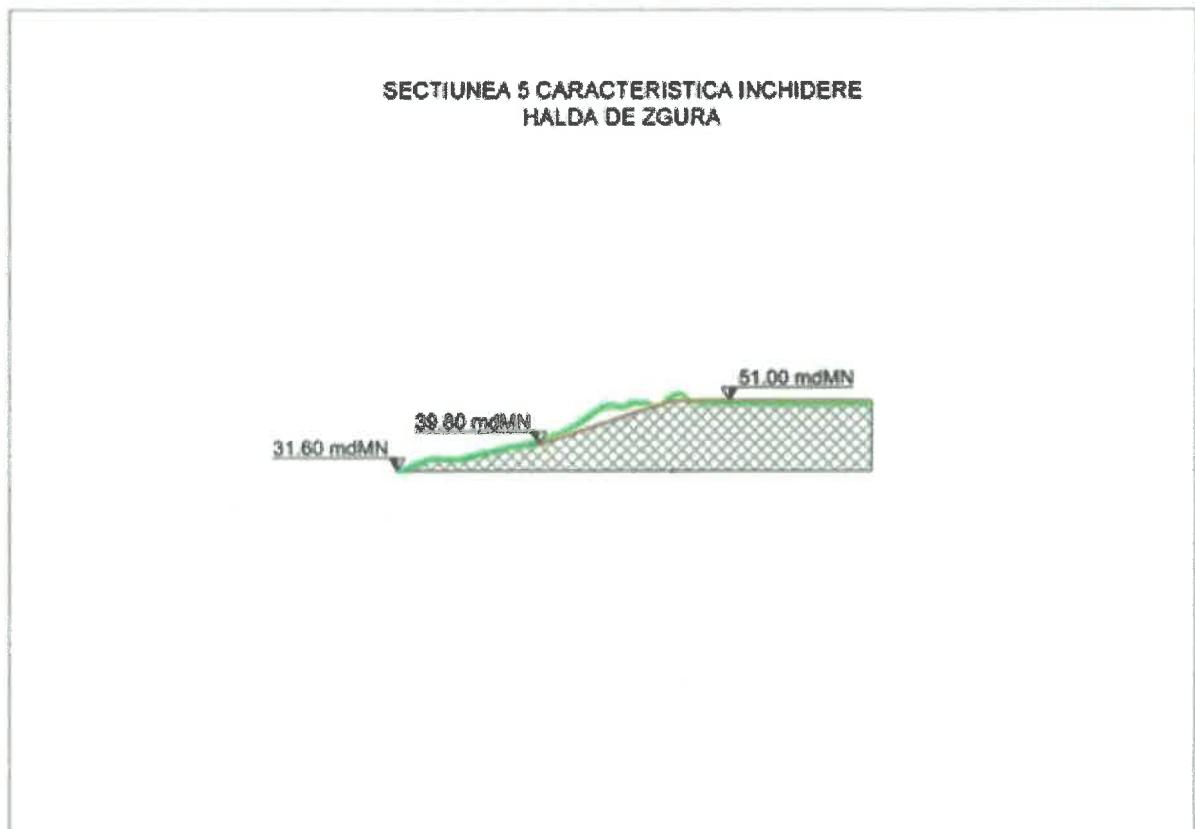
Figura 17 Secțiunea 5 caracteristică închidere haldă de zgură
