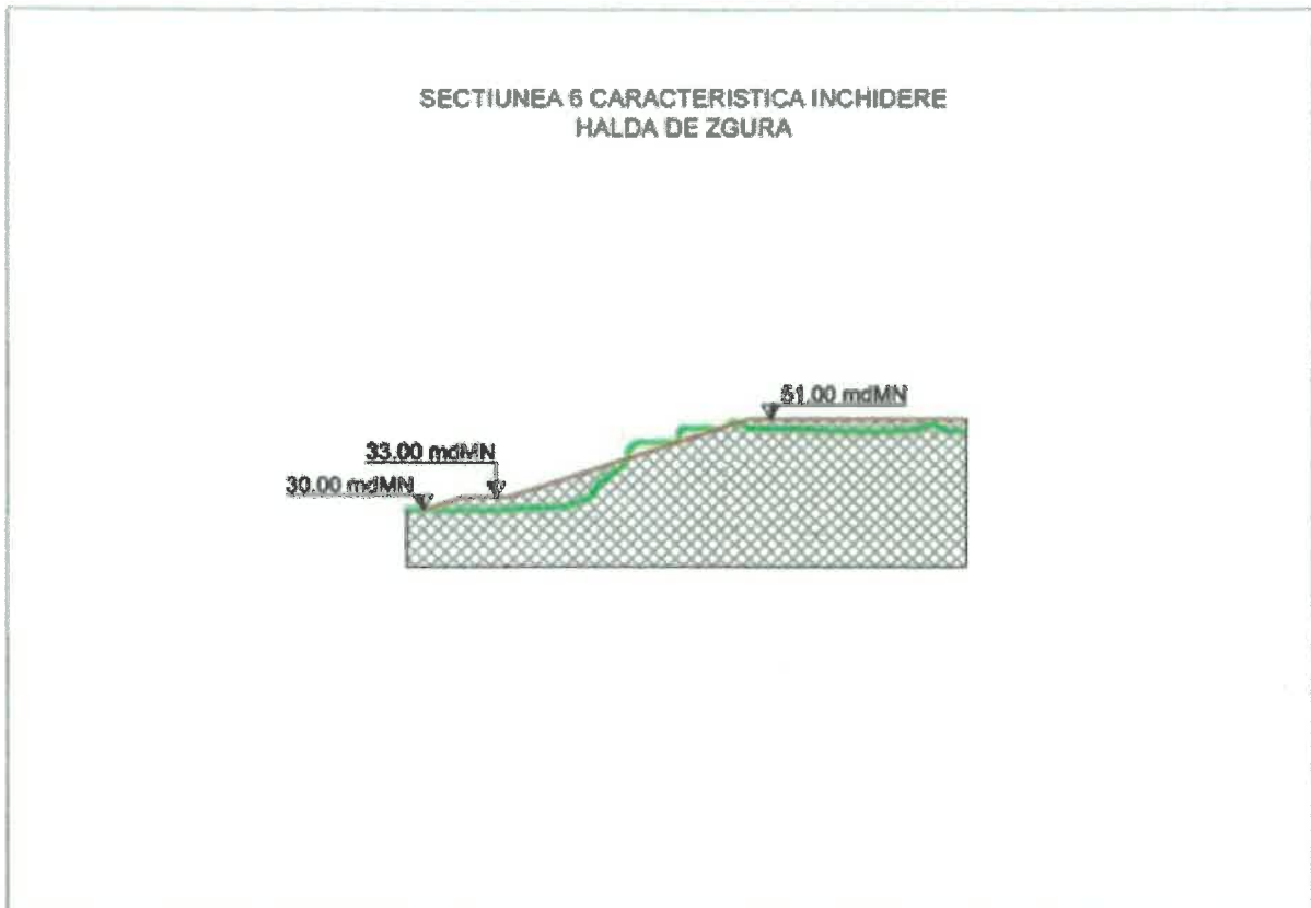
Figura 18 Secțiunea 6 caracteristică închidere haldă de zgură
