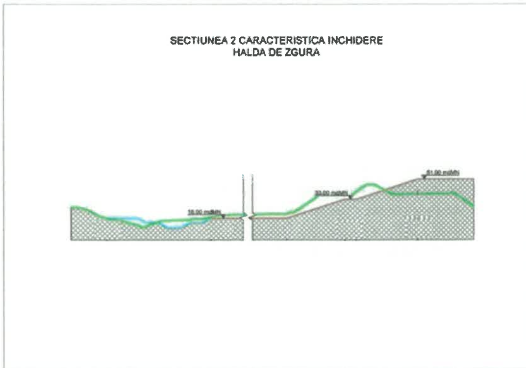
Figura 13 Secțiunea 2 caracteristică închidere haldă de zgură
