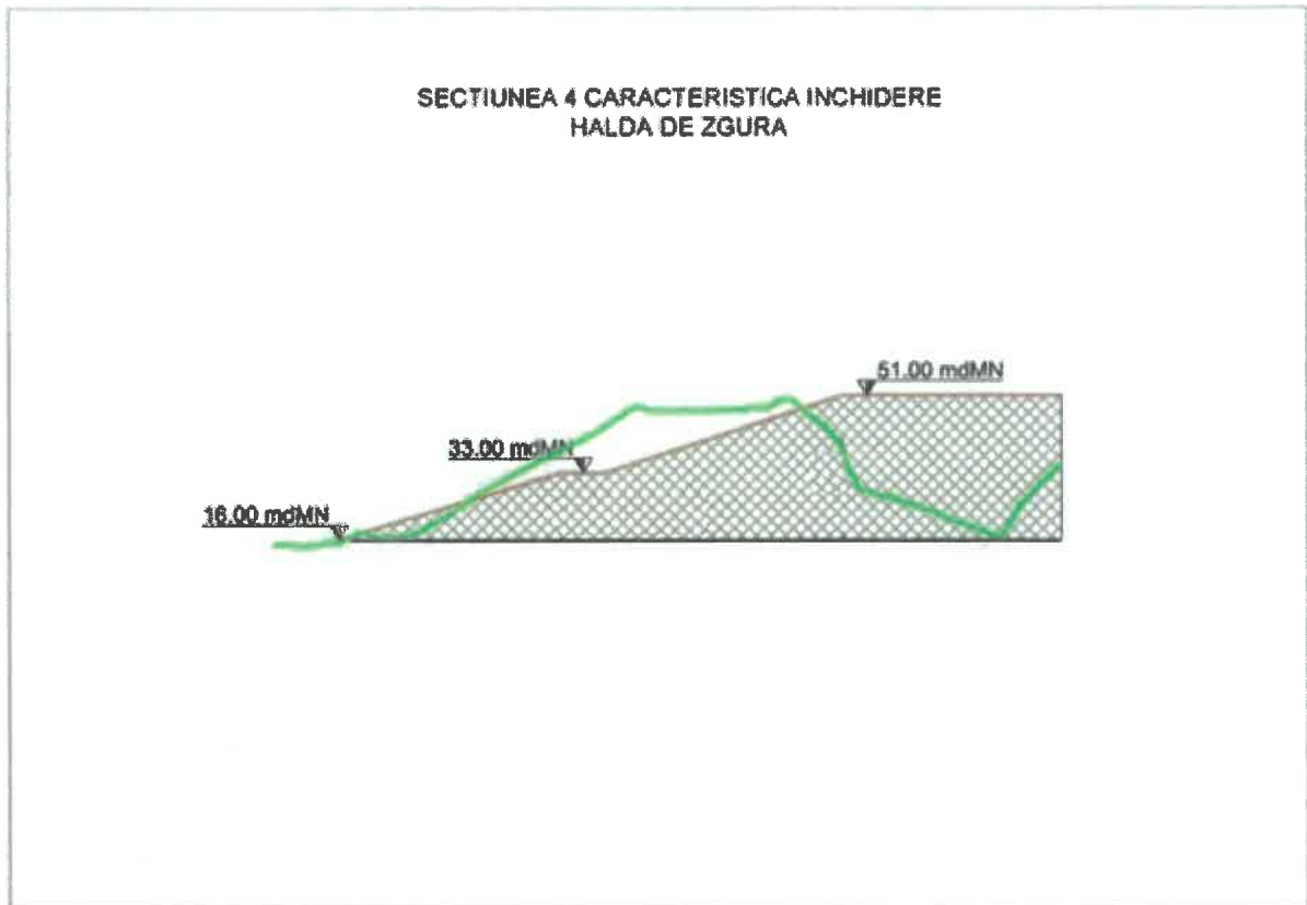
Figura 16 Secțiunea 4 caracteristică închidere haldă de zgură
