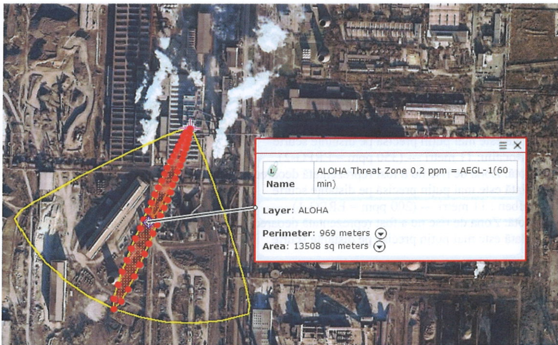
Zona de impact Convertizor nr. 3 – Dioxid de sulf ( \text{SO}_2 ) Galben: 480 m; Perimetru: 969 m; Suprafața: 13508 mp; Conc. 0,2 ppm = AEGL-1 (60 min)
