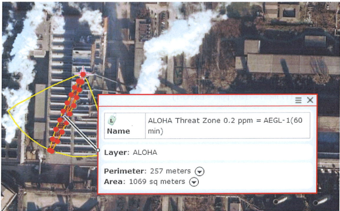
Zona de impact Convertizor nr. 1 – Dioxid de sulf (SO 2 ) Galben: 126 m; Perimetru: 257 m; Suprafața: 1069 mp; Conc.: 0,2 ppm = AEGL-1 (60 min)
